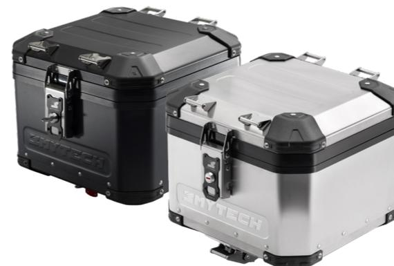
La nuova versione GSA monta sulla piastra originale BMW GS ADVENTURE ed è a sgancio rapido. Il sistema di aggancio funziona tramite una leva posizionata nella parte inferiore del bauletto ed un perno che dovrà essere ruotato per ¼ di giro sempre posizionato all'interno.
