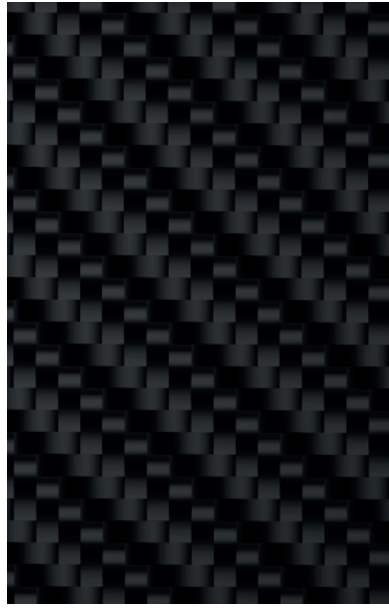
Fibra di carbonio - 44% Peso Carbon fiber - 44% Weight
