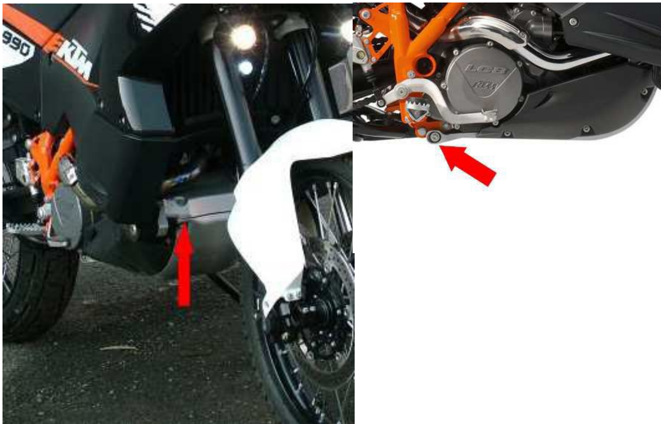
Figura 2: Smontaggio paramotore originale
